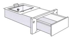
Schiebemulde als Durchgabe für den Einbau unter einer Schalterverglasung eines Außenwand-/Trennwandschalterfensters mit Rahmen nach FB6 und außenwand-
